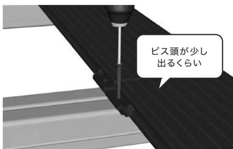
デッキにクリップをはめ、デッキが割り付けの線の位置にあることを確認し、黒いドリルビスを使ってクリップを固定していきます。この際、ビスは締め付けしないでください。締め付けると次の列のデッキがはまらなくなります。
